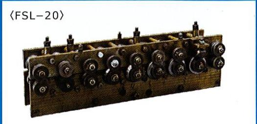
ボタンパンチスナップロック成型機(成型本体部品のみ)
