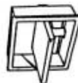
③スイング型排煙口(ダクト挿入)
